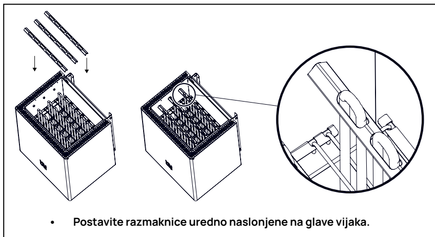
Slika 7 Instaliranje razmaknica grijaćih elemenata u HUUM CORE Wall i CORE Wall Combi.
