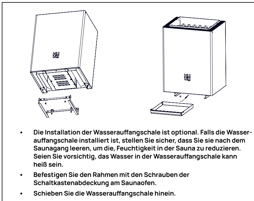
Abbildung 10. Installation der Wasserauffangwanne mit dem Rahmen.
